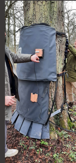
Université Bologne / Tree Hold / Greehill / EPV Traitement expérimental par chaleur contre le chancre bactérien - test 09/03/2023
